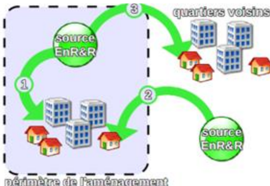
Figure 26 : Schéma de principe de mutualisation énergétique
