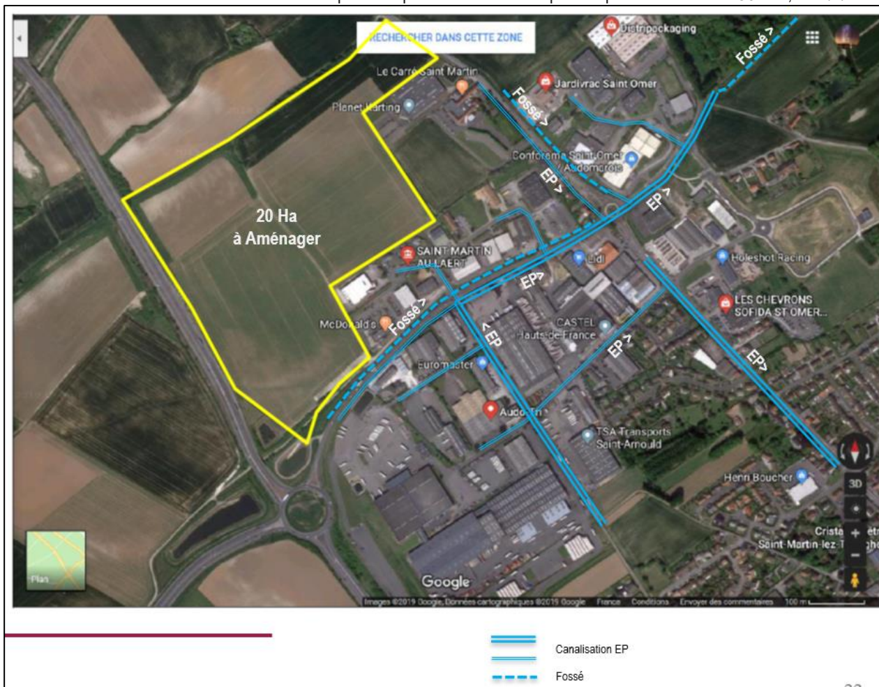
Document n° 30 : Réseau d'assainissement des eaux pluviales
