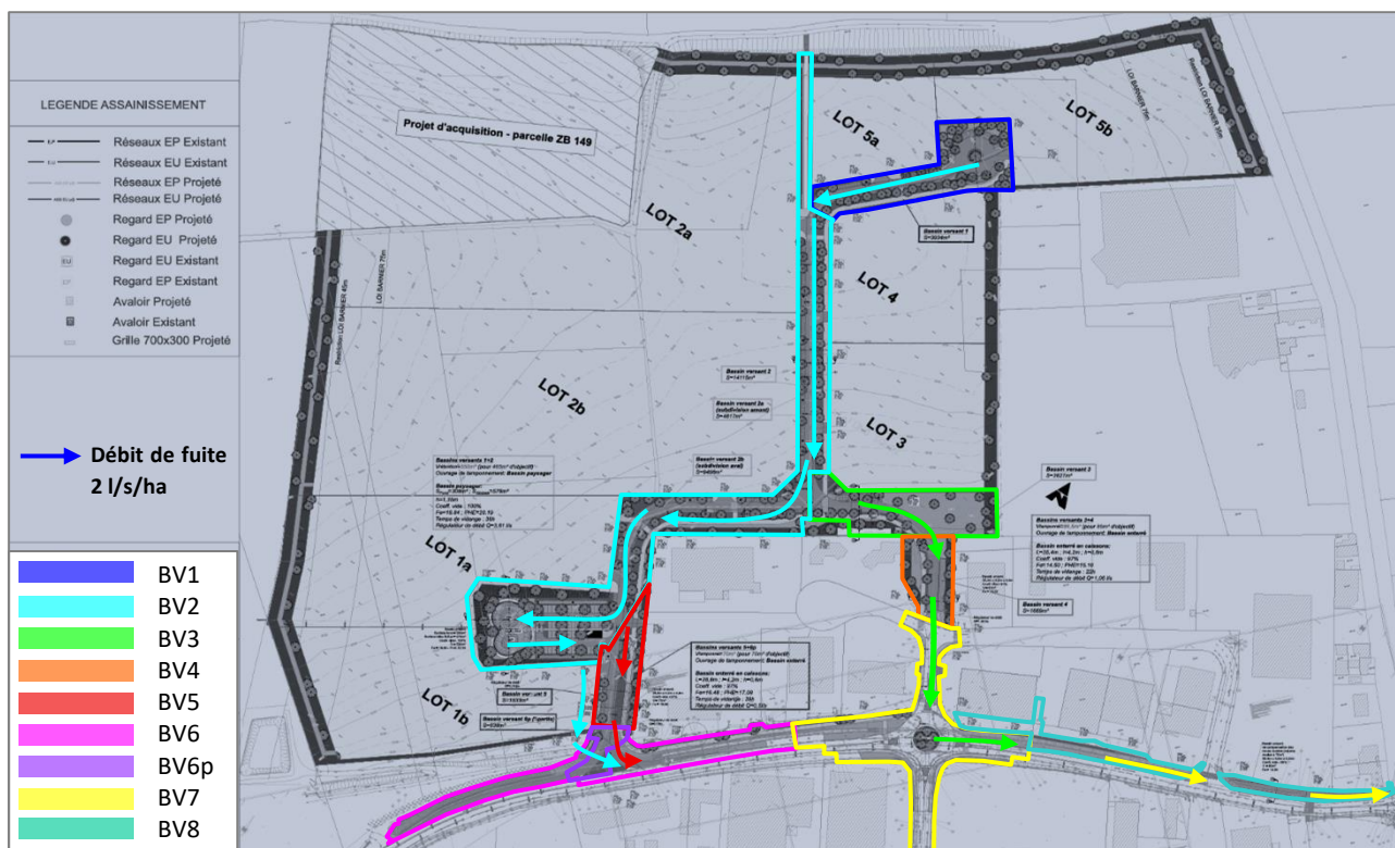
Document n°7 : Cheminement des eaux pluviales
