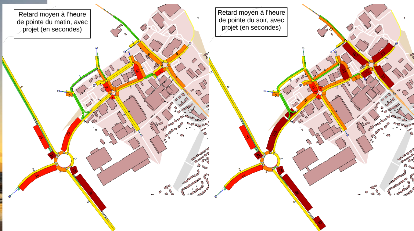
Document n° 79 : Résultats de la simulation à l'état futur avec projet en 2030, retards simulés à l'HPM et l'HPS.
