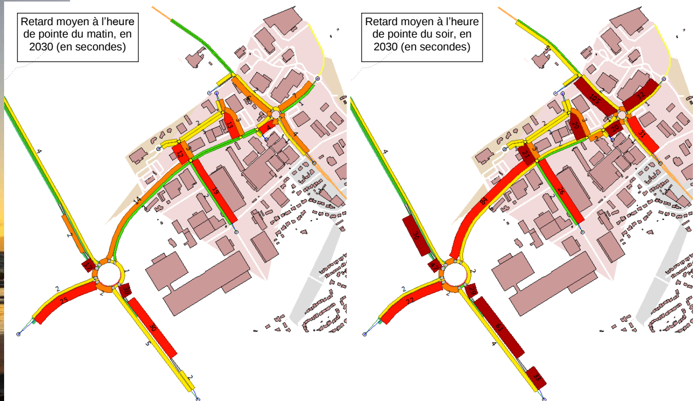
Document n° 61 : Résultats de la simulation en 2030, au fil de l'eau, retards simulés à l'HPM et l'HPS.
